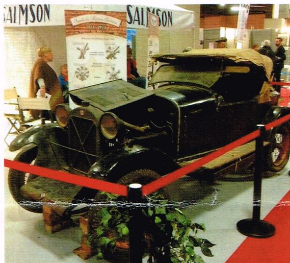
Sur le stand de l'Amicale Salmson, une Val 3 de 1924, préservée dans son jus. Cette "2+2" est propulsée par un 4 cylindres monoculbuteur de 1093 cc. Ses 8 soupapes sont commandées par 4 tiges et il développe 18 cv à 3200 trs/mn.
